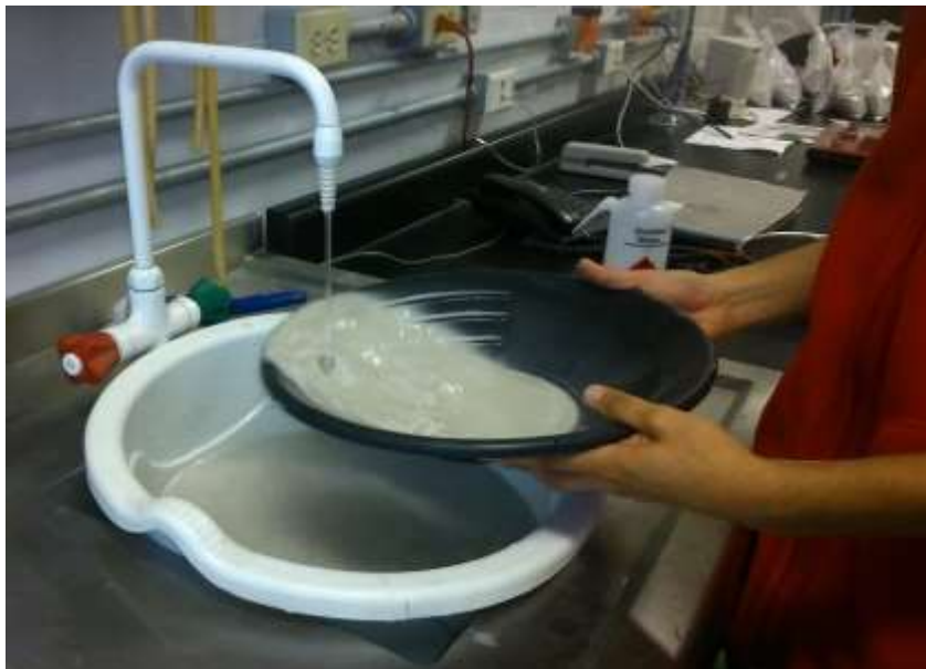
FIGURA 3. 5 MÉTODO DE CONCENTRACIÓN POR BATEA. SE MUESTRA UN PLATO TIPO "PAN CALIFORNIANO" CON UNA SERIE DE ESCALONES QUE IMPIDEN LA PERDIDA DE MINERALES MÁS DENSOS.
