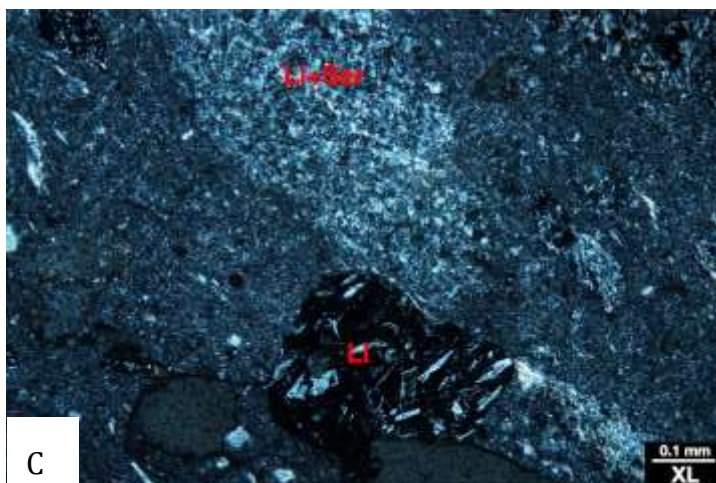
FIGURA 6 IGNIMBRITA LÍTICA. A) FIAMMES ALTERADOS POR FILOSILICATOS. B) CRISTALES DE CUARZO EN ZONA DE ALTA FRAGMENTACIÓN DE LA ROCA. C) LÍTICOS CARACTERÍSTICOS EN LA IGNIMBRITA. XL: NICOLES CRUZADOS.
