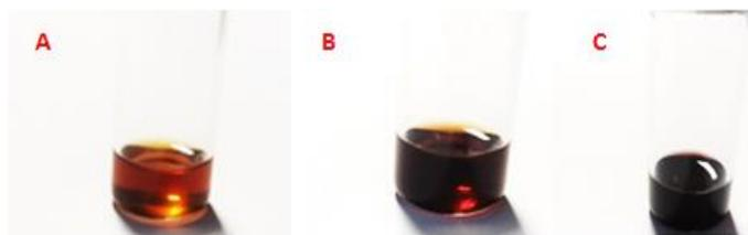
**Figura 4.9.** Ensayo del ácido cromotrópico: (A) Inicio del ensayo, (B) después 20 min a 75°C (C) después 65 min a 75°C.
