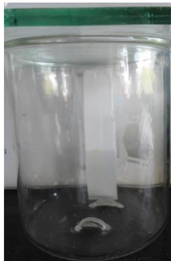
Figura 39 Cámara de elución utilizada para las placas con muestra de AE
