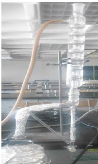
**Figura 20 Aparato de hidrodestilación**
