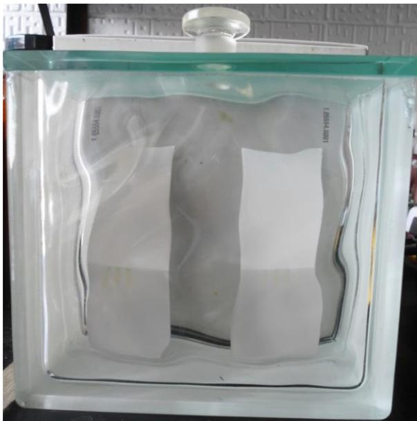
Figura 36 Cámara de elución para las placas con muestra del extracto Metanólico.
