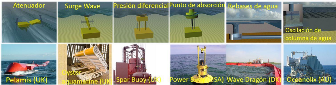
Figura 3.4.1. Tipos de dispositivos con relación a su modo de absorción de energía del oleaje.
