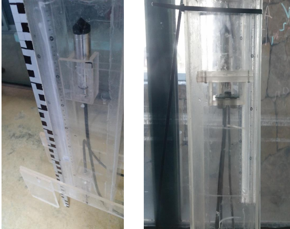
Figura 4.3.3 Graduación de la regla para la medición de la oscilación de la columna de agua. Sensor ultrasónico utilizado para medir la variación en la columna de agua
