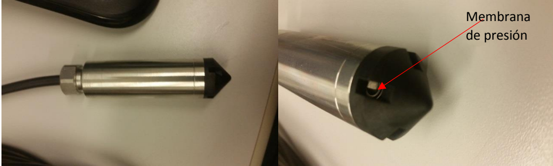
Figura 4.3.5. Sensor de presión S30X Keller®, utilizado para la experimentación, se puede observar la membrana dentro del conducto del sensor, debido a eso es posible que se genere la burbuja de aire al estar sumergido.
