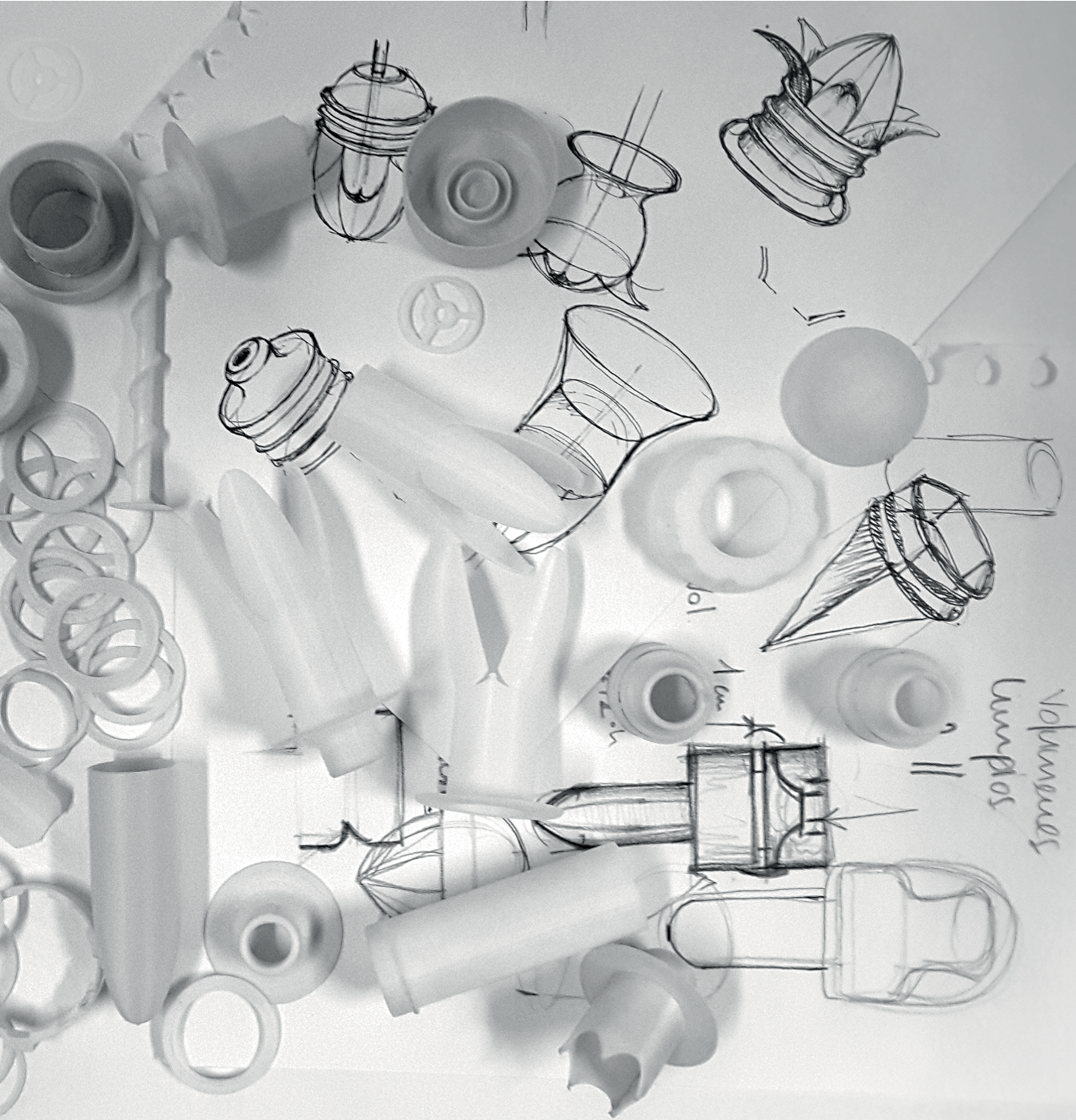
FIG. 155. Piezas en manufactura aditiva.
