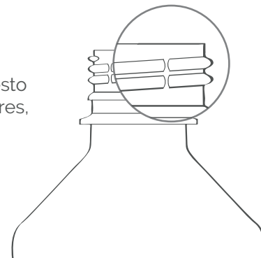
FIG. 16. Paso de rosca de botella de bebida presurizada.
