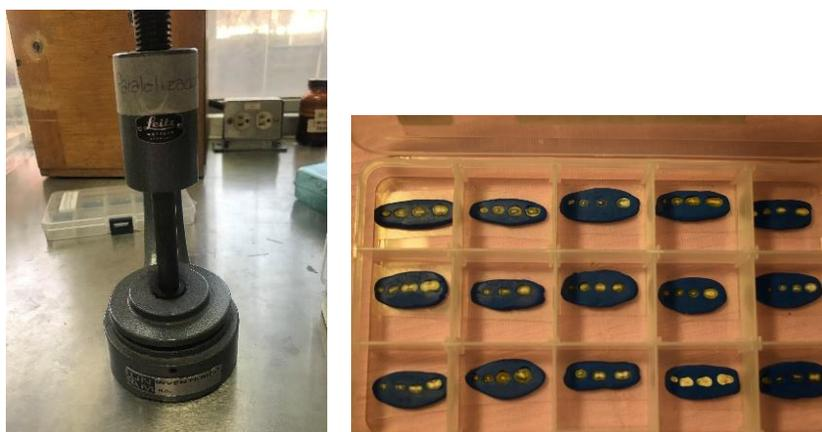
Fig. 54 Paralelizado de las muestras y guardado en cajas
