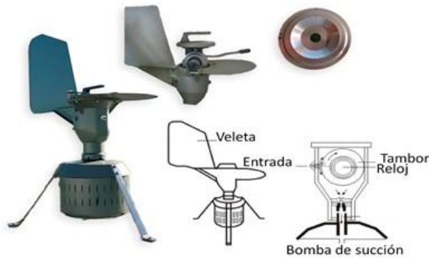
Figura 21. Trampa de esporas tipo Hirst Burkard, así como esquema de funcionamiento basado en el fundamento teórico de succión e impactación (modificado de Red española de aerobiología 2016).
