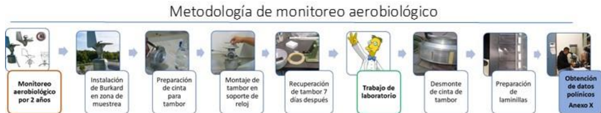
Figura 20: Proceso general de obtención de muestras y datos por medio de una trampa de esporas tipo Hirst
