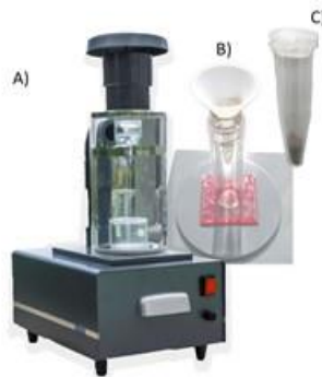
Figura 26. Muestreador Jet Sampler modificado por REMA. A) Jet Sampler, B) Modificación en acrílico para la recolección de partículas en un tubo Eppendorf de 1.5mL., C) Tubo Eppendorf con muestra colectada.
