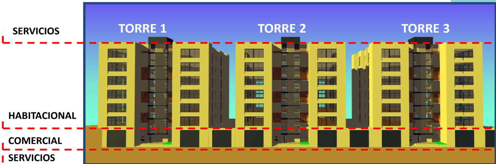
Img. 49.- Fachada esquemática frontal del proyecto
