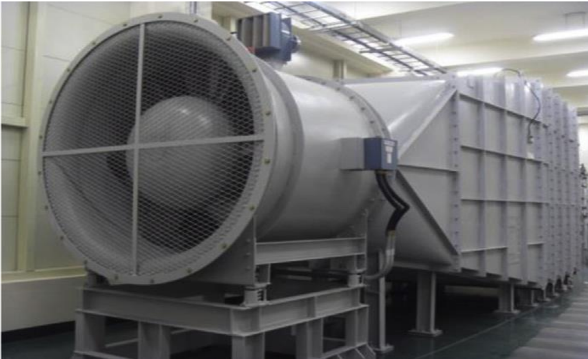
Vista posterior del tipo de circuito abierto el túnel de viento subsónico
