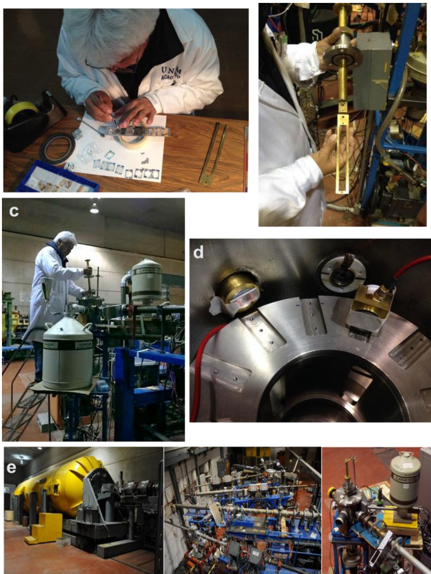
Figura 25. Proceso de montaje y equipos que componen el método de análisis PIXE. a) montaje de las muestras en la regleta metálica sobre la que incide el haz de protones. b) Sostén metálico sobre el que se monta la regleta y que se ajusta en la cima de la cámara de vacío. c) colocación del sostén metálico en la cámara de vacío. d) vista dentro de la cámara de vacío, se muestran las entradas del haz de protones y dos detectores. e) acelerador de partículas Van der Graff (izq), conductos por tipo de partícula producidos (medio), entrada de cada conducto en la cámara de vacío (der).
