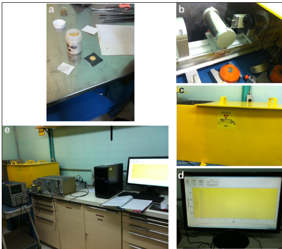
Figura 32. Montaje de muestras en el Espectrómetro Mössbauer, en el Instituto Nacional de Investigaciones Nucleares (ININ)., a) Se muestra el recipiente con la muestra pulverizada y con la placa de color negro donde se coloca una película delgada de la muestra pulverizada, la cual es retenida por una resina por la parte posterior; b) el cilindro observado es donde se produce el efecto Doppler y el dispositivo color naranja en forma de disco en la parte inferior, es la fuente de cobalto-57; c) coraza de plomo que aísla el equipo del exterior o protege al operador de la emisiones gamma generadas por la fuente radioactiva dentro del mismo; d) monitor, donde se muestra el Espectro Mössbauer que describe las interacciones hiperfinas de la muestra analizada; e) estación de análisis del ININ.
