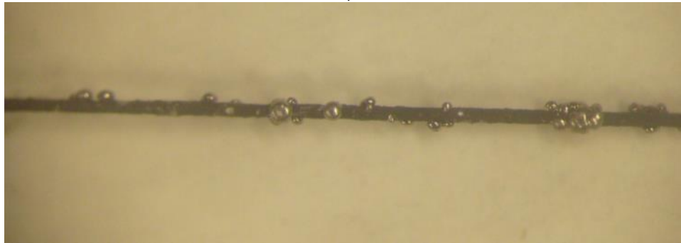
Figura 4.20. Fibra óptica 180 \mu m de diámetro después del niquelado a) un extremo, b) parte media.
