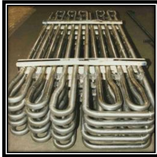
figura 3.10 Recalentadores de vapor
