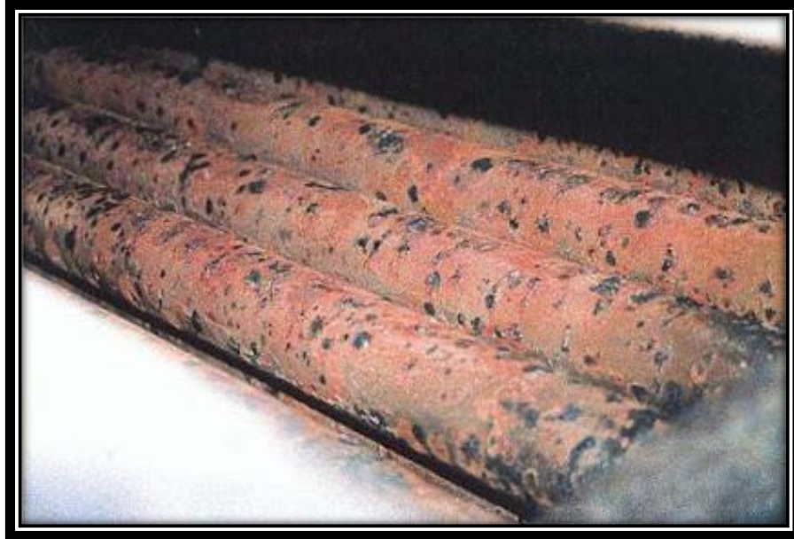
Figura 4. 3 Corrosión en tubos de humo por pitting
