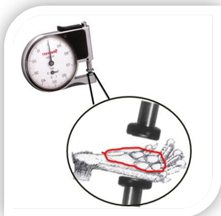
Figura 21 Medición de los cojinetes plantares. En esta imagen se muestra el proceso exacto de cómo es que deben de ser medidos correctamente.
