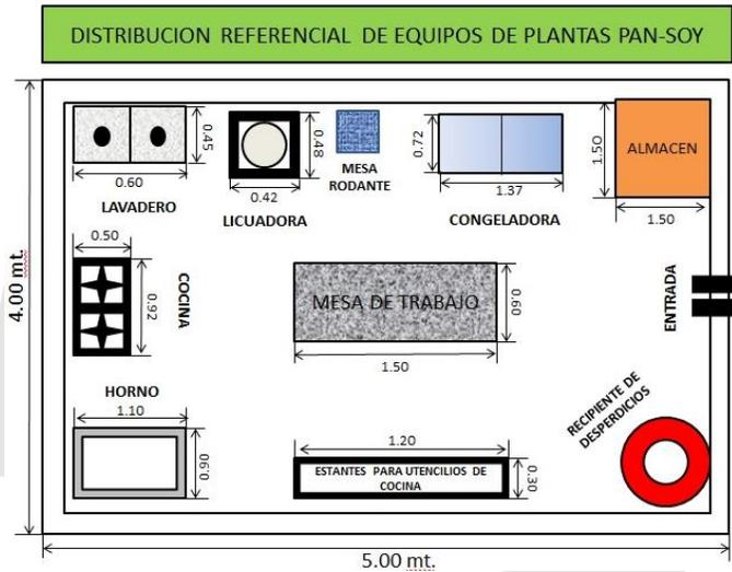
Ilustración 65 Esquema de una Panadería (PAN-SOY, 2017)
