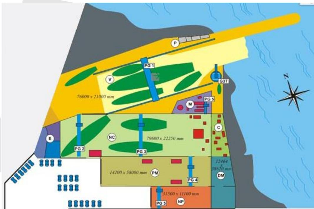
Ilustración 94 Zonificación Astillero Federico Contessi (Astillero Naval Federico Contessi y Cía. S.A, s.f.)
