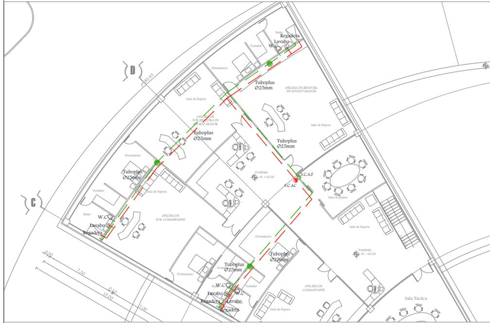
**Planta Alta Instalación Hidráulica**
