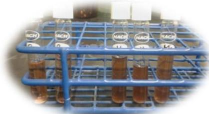
**Figura 11. Reacción de la prueba Demanda Química de Oxígeno.** Celdas procesadas con el digestor.
