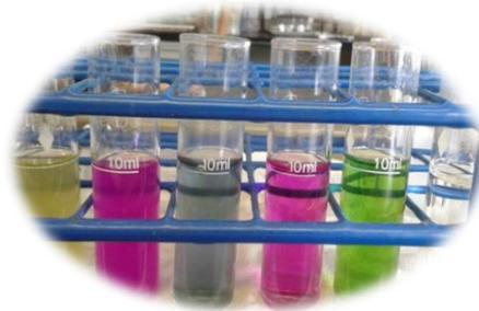
**Figura 9. Técnica por colorimetría para nutrientes.** Celdas con comprimidos para lectura de nutrientes.
