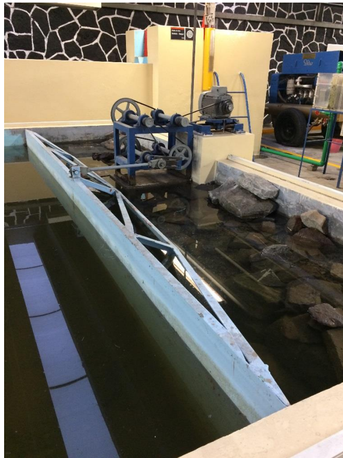
Figura 3.1.3 Sistema de poleas y paleta tipo flap con una distancia de empuje regulable
