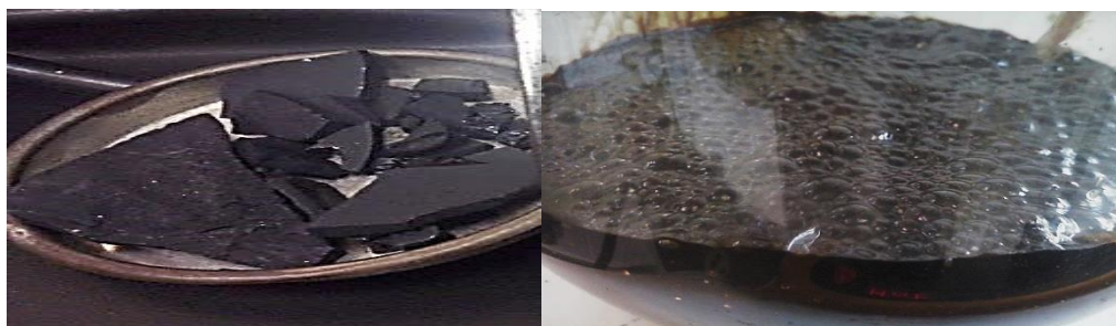
Figura 20. Apariencia de los Asfaltenos (Izquierda) y Maltenos (Derecha).
