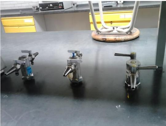
Válvulas sin identificación ni mantenimiento.
