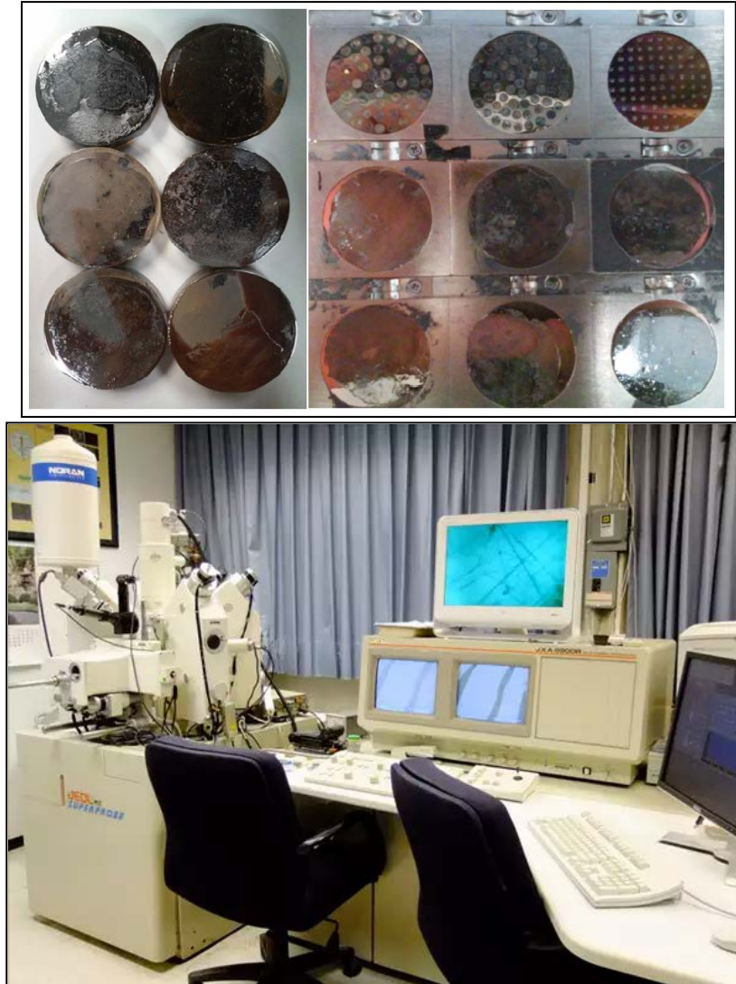
Figura 4.2. (Arriba, Izquierda) Muestras con película de carbón para análisis EPMA, (Arriba, Derecha) Ubicación de las muestras en la platina; (Abajo) Equipo para análisis de microsonda electrónica (ZEISS, Modelo EVO MA 10) del Laboratorio de microscopía electrónica y microanálisis del Instituto de Geología, Ciudad Universitaria.
