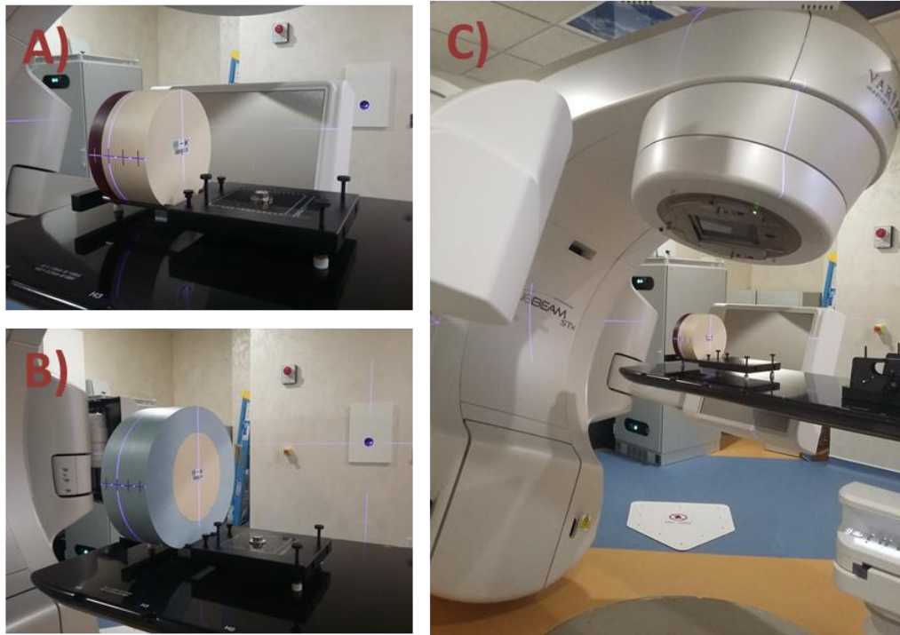
Figura 3.11. Se muestra el maniquí de calidad de imagen posicionado en un sistema de adquisición de imagen CBCT. A) Adquisición de imagen de maniquí simulando cabeza, B) maniquí que simula tórax o abdomen (usando el complemento anular) y C) alineación del maniquí en el sistema CBCT.
