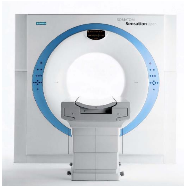
Figura 3.7. Tomógrafo helicoidal de tercera generación Somatom Sensation Open de Siemens dedicado exclusivamente para simulación de planes de tratamiento de radioterapia en el Hospital "1".
