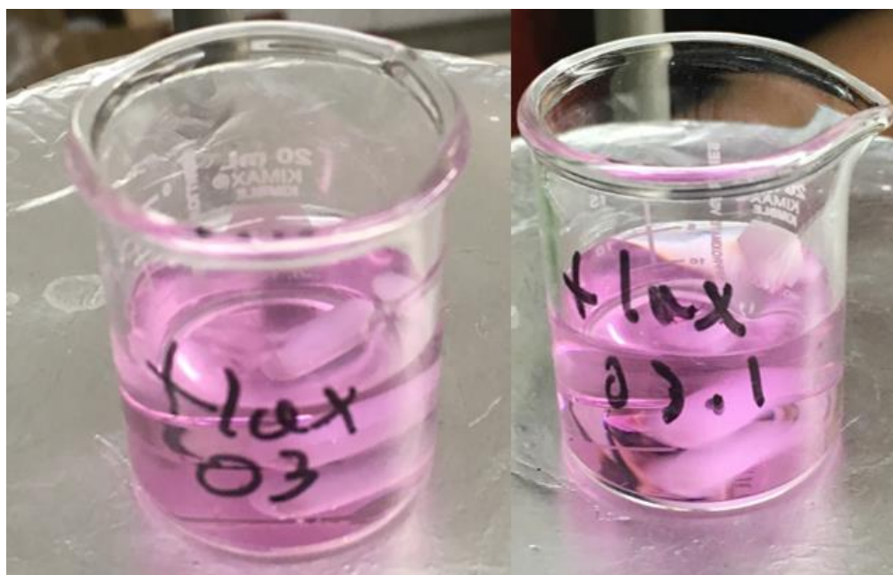
Figura 36.- Muestras de Tlax-03 después de agregar fenolftaleína.
