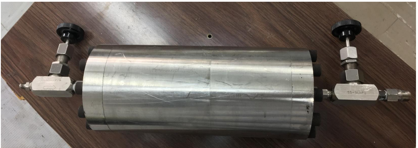
Figura 38.- Fotografía de la celda cilíndrica restaurada.
