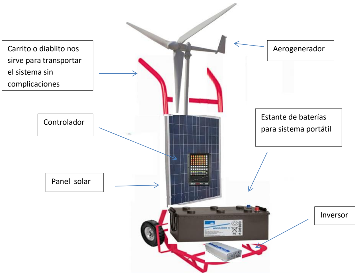
Fig. 7.3: fuente de generación eléctrica portátil para carrito de desastres
