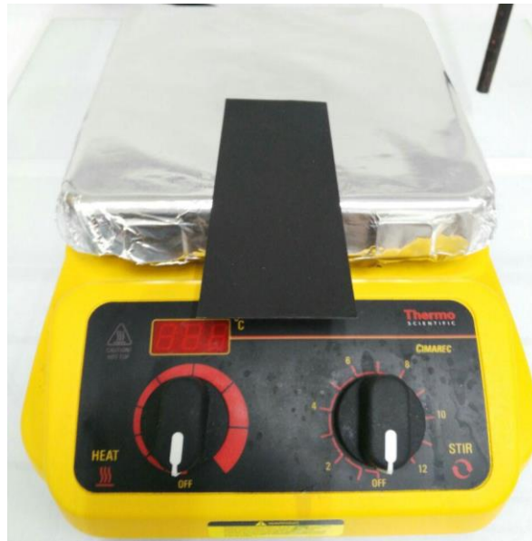
Figura 7.2. Disposición de la barra metálica sobre la parrilla. La mitad de la barra permanece en contacto con la parrilla, mientras que el resto se encuentra expuesta en su totalidad al ambiente.
