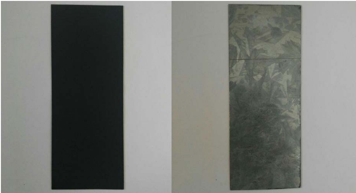
Figura 7. Barra de acero pintada (Izquierda) y sin pintar (Derecha)
