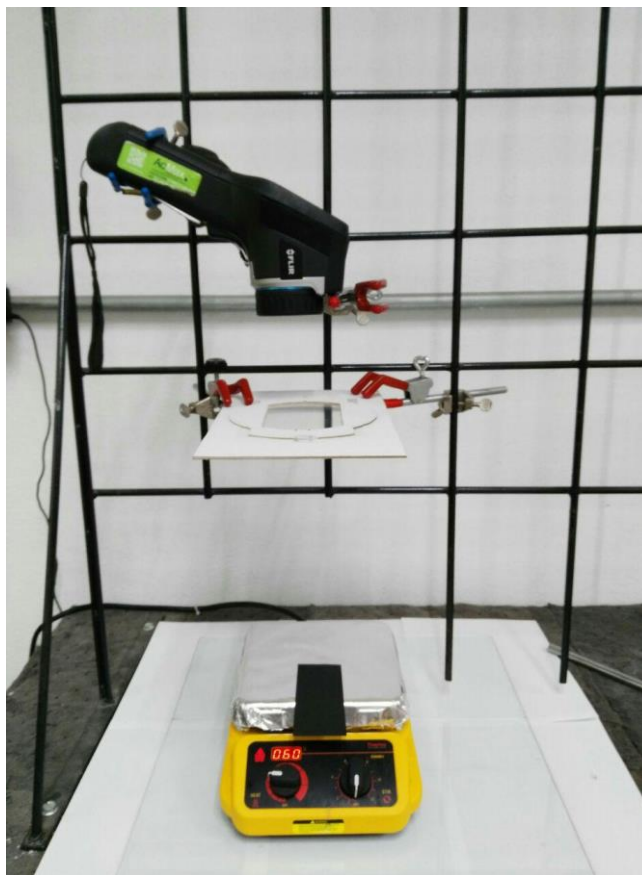
Figura 7.3. Montaje experimental. En la imagen se pueden apreciar la cámara termográfica (arriba), el marco portamuestras (en medio) y la parrilla de calentamiento (abajo).
