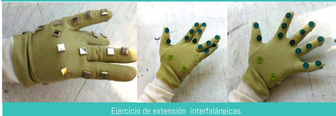
Figura.68 prototipo 2, para verificación de sensores y motores de vibración
