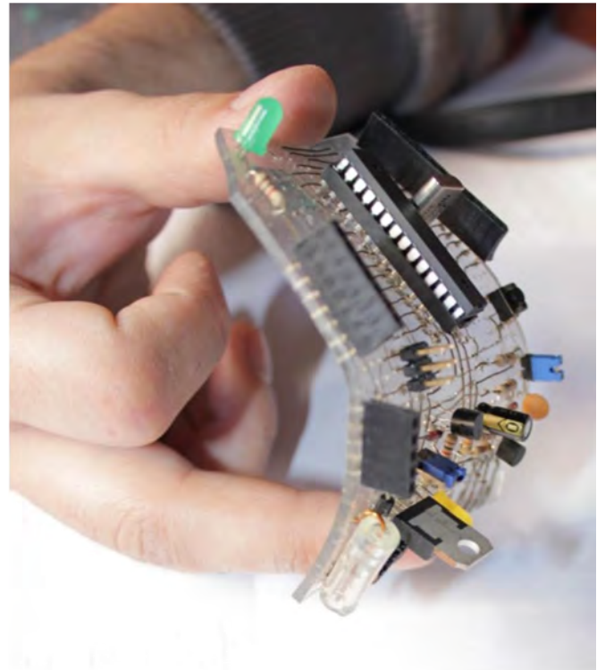
Figura 72 Técnica de producción de circuitos sobre plástico flexible, o PCBs (printed circuit boards o circuitos impresos) y miniaturización de elementos
