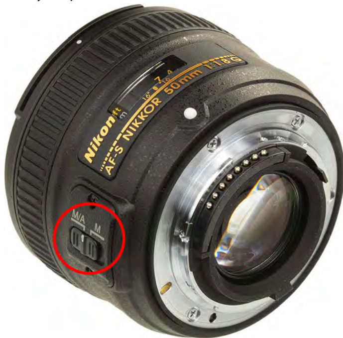
Localización de los modos de enfoque en un objetivo
