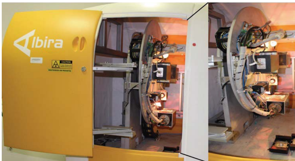
Fig. 7 Esquema del interior del sistema trimodal Albira Suite con sus respectivas modalidades (PET/SPECT/CT)(Oncovisión, España).
