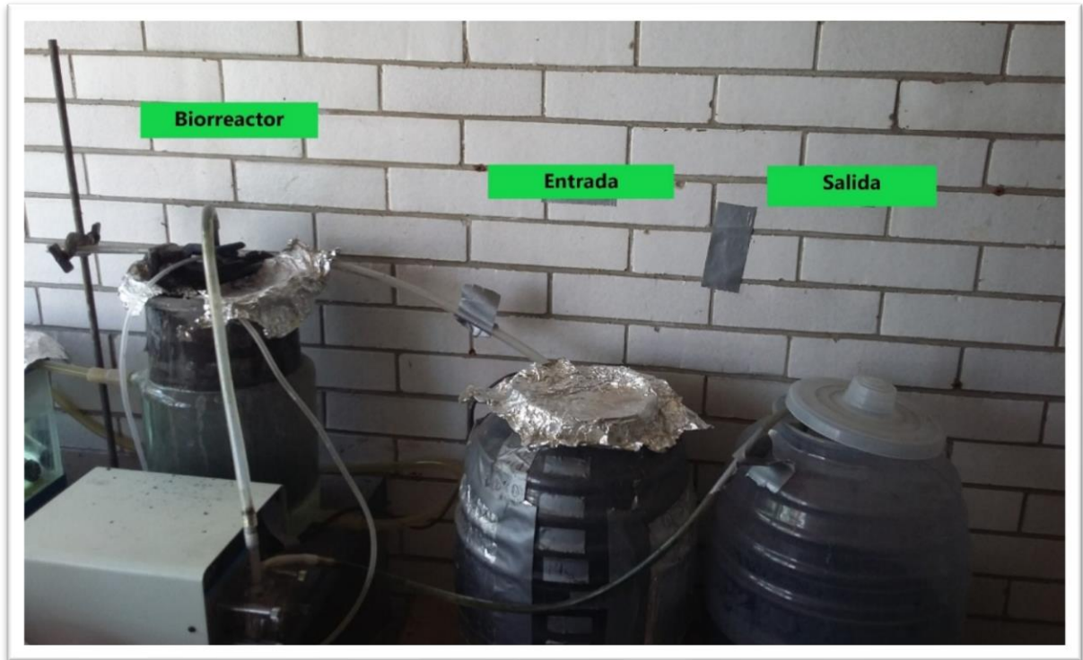
Figura 2. Sistema Piloto de Lodos Activados a Nivel de Laboratorio.
