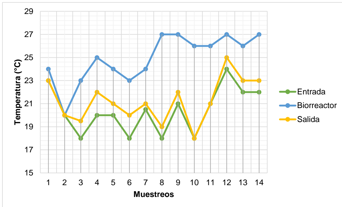
Figura 9. Valores de temperatura registrados en el sistema piloto de lodos activados durante todo el período de muestreo.
