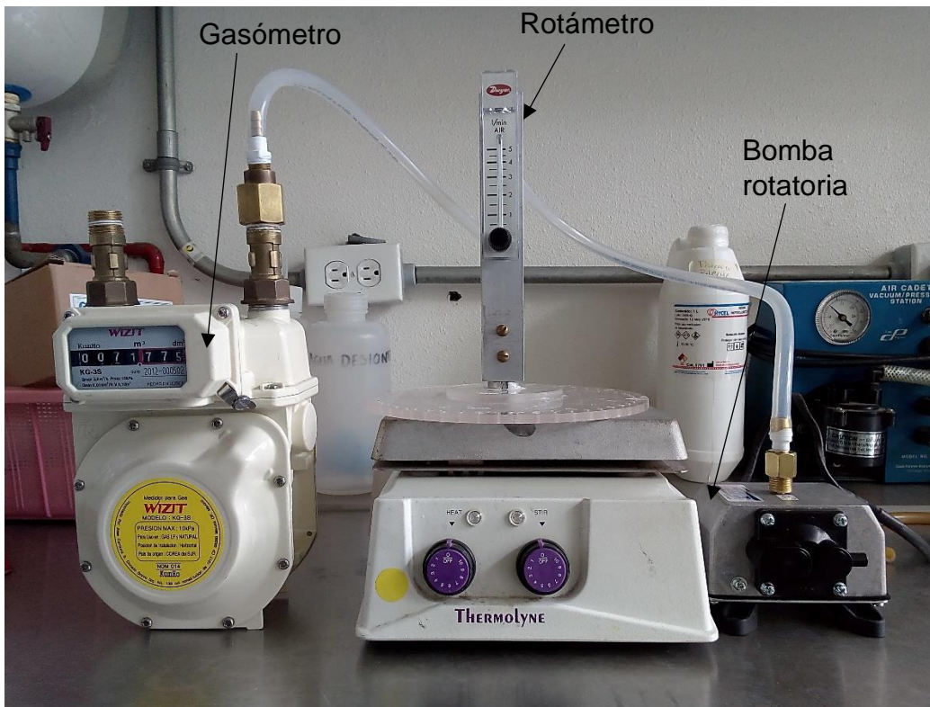
Figura 13. Calibración del rotámetro con la bomba rotatoria.
