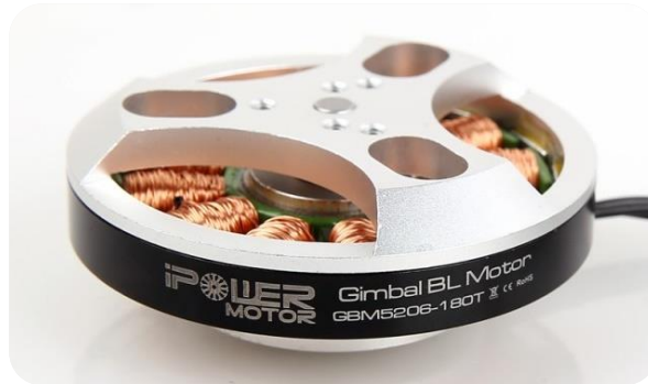
Figura 3.14 Actuador sin escobillas utilizado para el gimbal.
