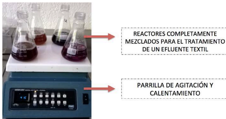
Figura 6.2 Sistema experimental para el tratamiento del efluente textil
