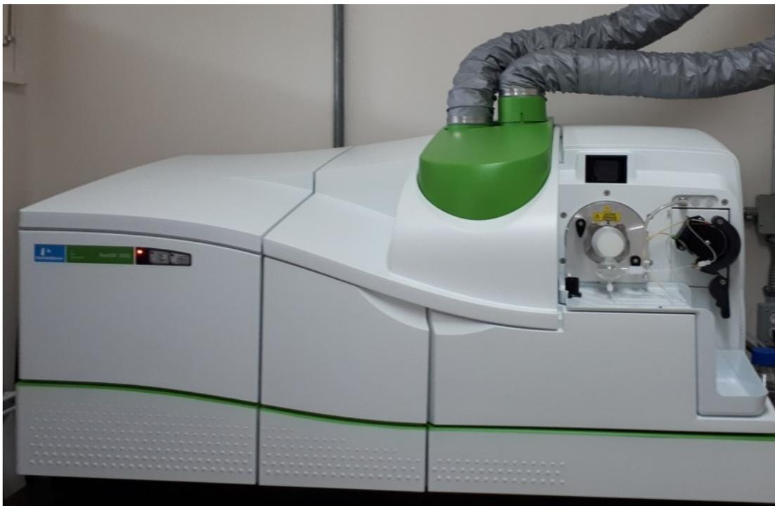
Fig. 2.16. Espectrómetro de masas con plasma acoplado, marca Perkin Elmer, Modelo: NexION™ 300 D.
