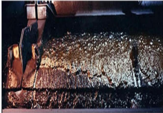
Primer plano de la celda de flotación
