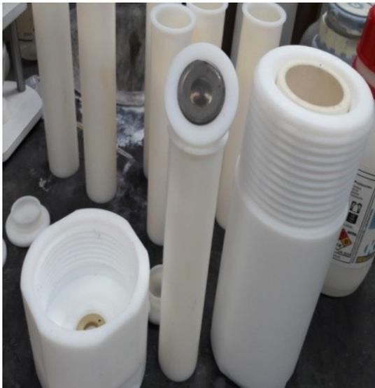
Fig. 4.1. Reactores para horno de microondas.
