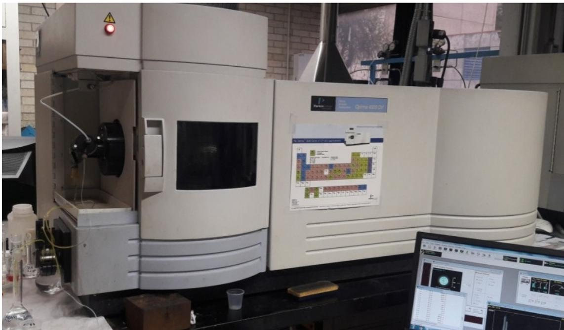
Fig. 2.11. Espectrómetro de emisión con plasma de acoplamiento inductivo, Marca: Perkin Elmer, Modelo: 4300 DV.
