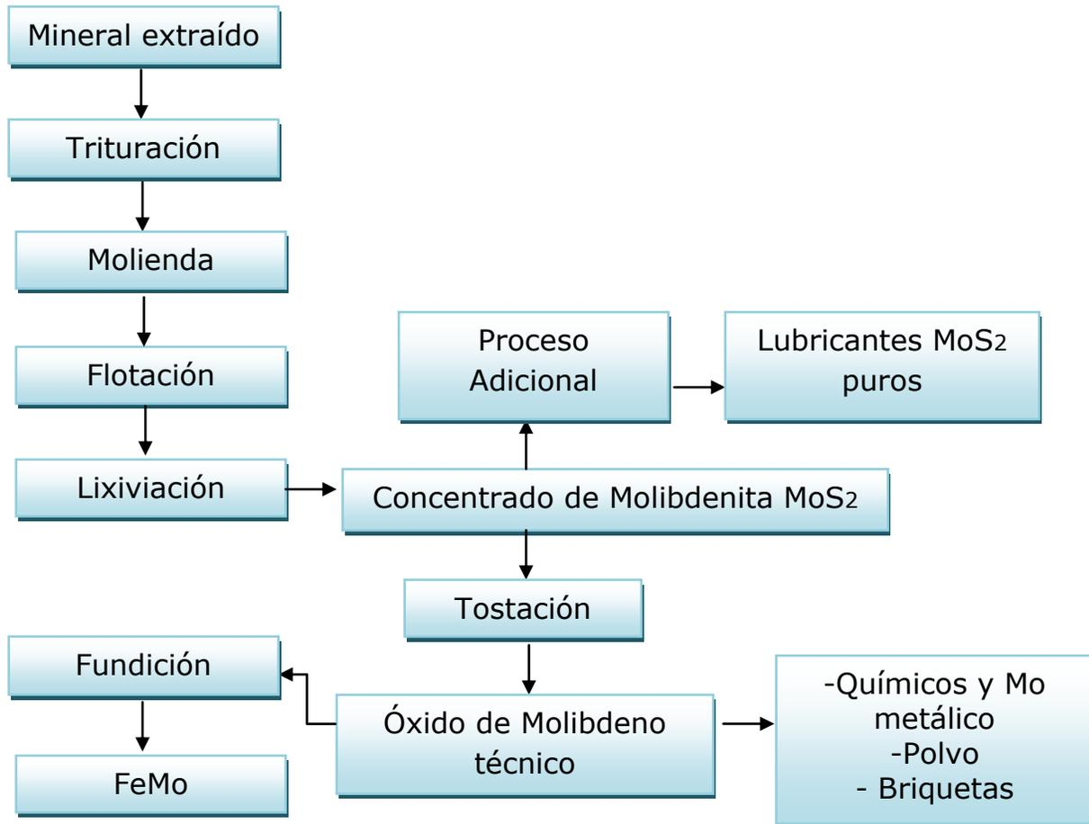
Fig. 1.5. Diagrama de flujo del procesamiento de molibdeno.
