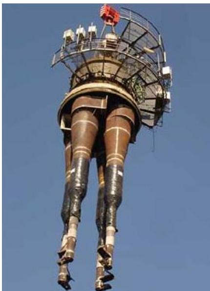
Figura 2.4 Ciclones a la salida del 'riser'. [MAN Reactors,2017]
