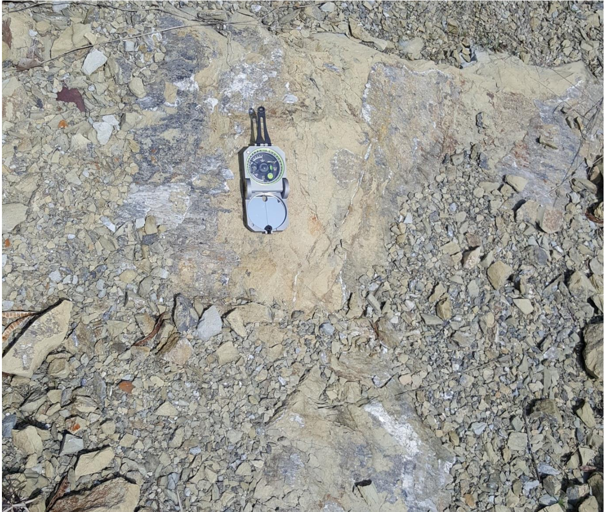
Figura 4.28 Estrías y escamas de calcita encontradas sobre el plano de falla los cuales son indicadores cinemáticos del movimiento correspondiente de la falla inversa encontrada sobre la terracería hacia el poblado de Tula.
