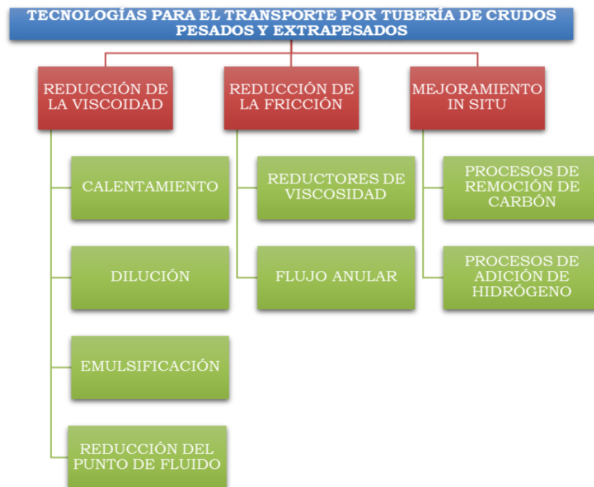
Figura 4. Tecnologías para el transporte de crudos pesados y extrapesados.
