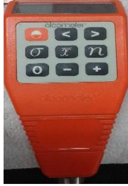
Figura 4.1. Medidor de espesores Elcometer.
