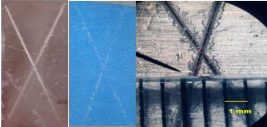
Figura 5.33. Resultados de la prueba de adherencia para 3 capas de policetona sin pigmento.
