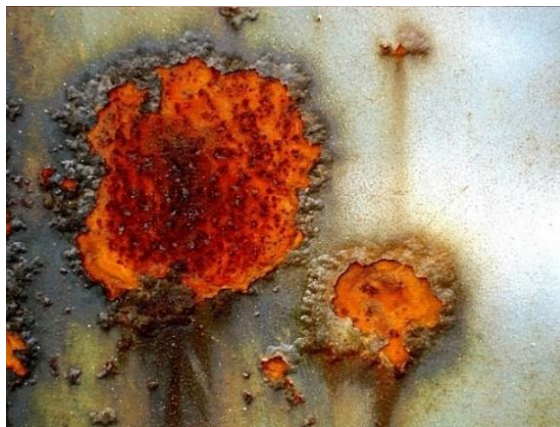
Figura 1.4. Ejemplo de corrosión localizada [6].
