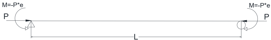
Figura 7.3 Viga con carga equivalente debida al presfuerzo
