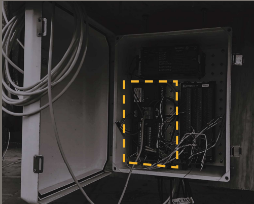
Figura 30. Datalogger y equipo de cómputo para el almacenamiento de los datos. Elaboración propia.
