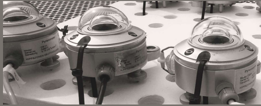
Figura 28. Calibración de piranómetros. Elaboración propia.
