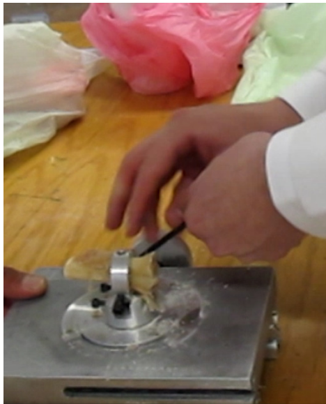
Figura 38. En esta imagen se observa el momento en que se sujeta el injerto con los pernos del anillo.
