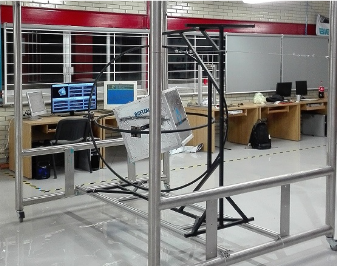
Figura 4.3: Instalación del banco de prueba, el cual incluye una estructura giroscópica y una estructura cubica.
