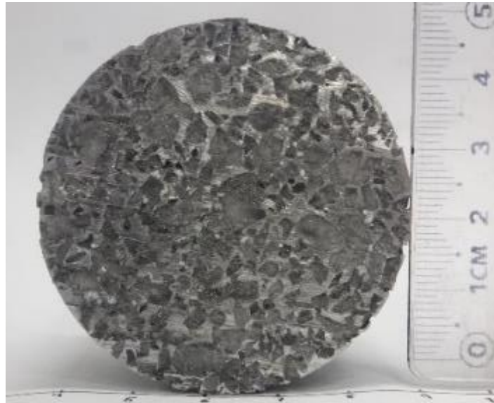
Ilustración 57 Espuma relación 2:1, vista superior, NaCl en la matriz.
