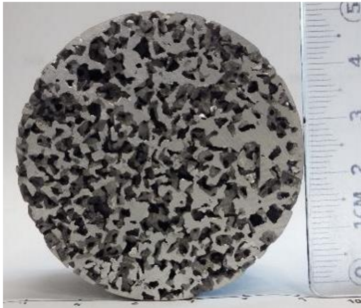
Ilustración 63 Espuma relación 4:1, vista superior, matriz de NaCl disuelta.
