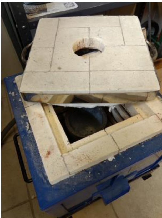
Ilustración 40 Horno de resistencias empleado para la fabricación de las espumas.
