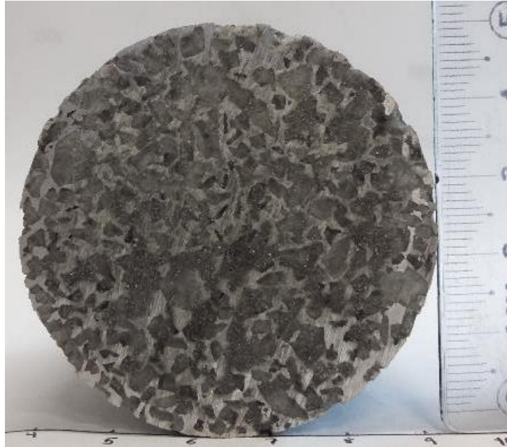
Ilustración 62 Espuma relación 4:1, vista superior, NaCl en la matriz.
