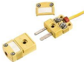
Figura 3.2 Esquema general del desarme del conector para el anclaje de los alambres de Ni-Al y Ni-Cr
