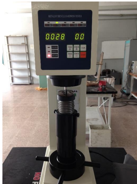
Figura 3.16 Durómetro Brinell utilizado para determinar la dureza.
