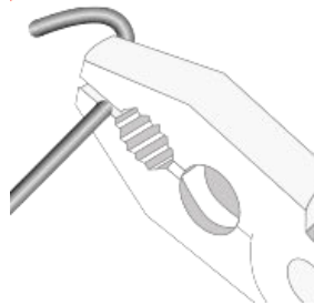
Figura 3.3 El gancho en el alambre facilitará el anclaje de estos en los tornillos
