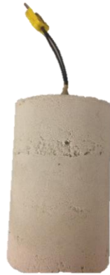
Figura 3.5 Termopar acoplado al molde de silicato – CO 2 .
