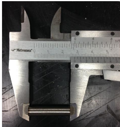
Figura 3.18 Longitud inicial de la probeta ensayada. 2.75cm de longitud.
