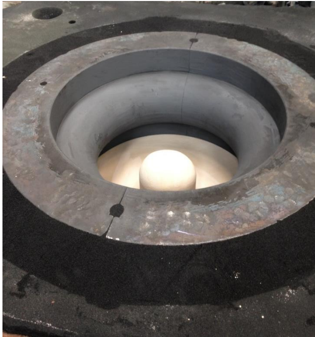
Figura 3.8 Molde de la pieza prototipo de FYMSSSA. Molde metálico.
