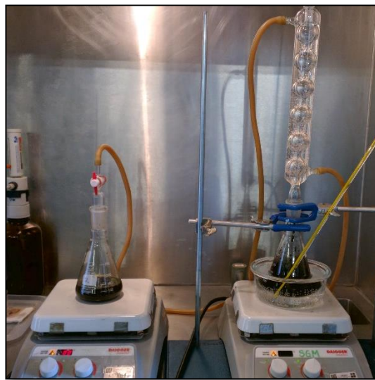
Figura 5.5 Arreglo para el pretratamiento con organosolv.
