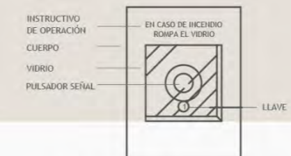
ESTACIÓN MANUAL COMPUESTA
