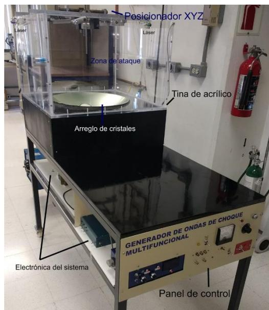
Figura 3.2 Generador de Ondas de Choque Multifuncional.
