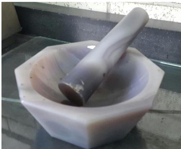
*Figura 15. Mortero de ágata utilizado para moler las muestras*
