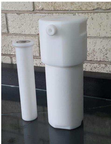
*Figura 17. Ejemplo de un vaso de reacción junto con su contenedor de seguridad*
