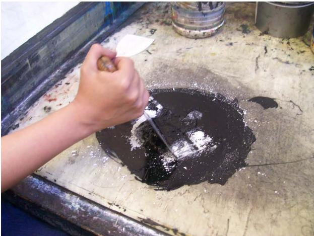
Figura 45: Preparación de tinta.
