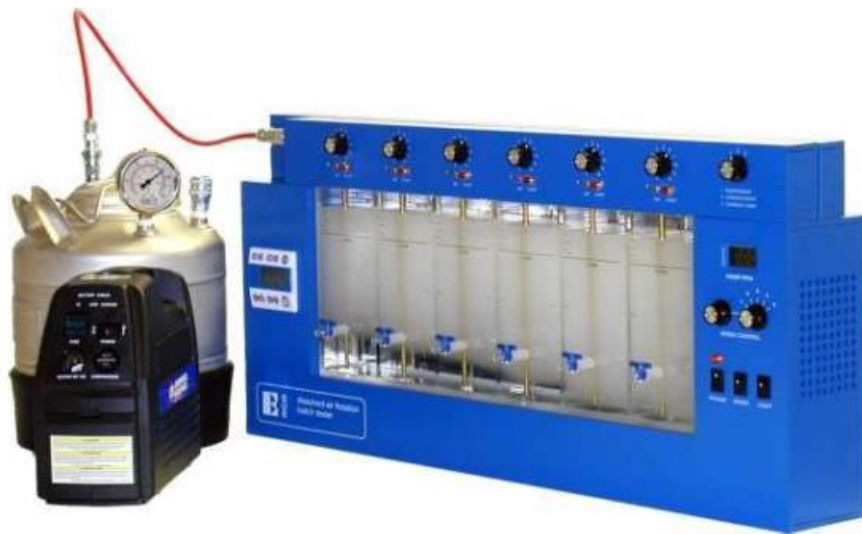
Figura 4.2 Equipo de pruebas de coagulación-floculación con flotación con aire disuelto para potabilización de agua, marca ECE
