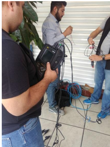
Figura 4.31. Conexión del analizador
