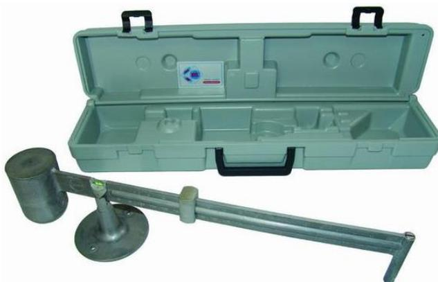
Figura 5.1.2.1 Balanza Baroid para medir la densidad
