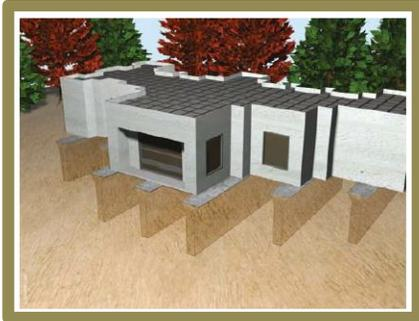
Mejoramiento de suelos compresibles en áreas con una carga extraordinaria, por medio de la construcción de muros de forma paralela o en cuadrícula: unidades industriales y almacenes, áreas de almacén de materiales, carreteras y terraplenes ferroviarios. Referencia: Guía Técnica Soletanche - Bachy
