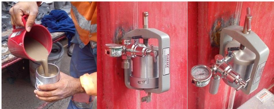
Figura 5.1.2.3 Prueba de película impermeable (*cake*).
