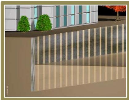
Incrementar la estabilidad en taludes mediante la construcción de muros transversales de alta resistencia: Cortes carreteros en materiales blandos, excavaciones a cielo abierto con reforzamiento de taludes, etc. Referencia: Guía Técnica Soletanche - Bachy
