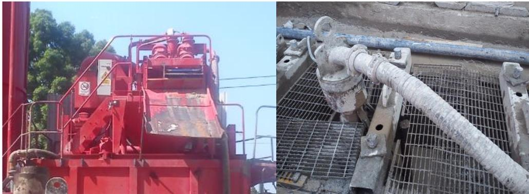
**Figura 5.1.2.5b** Desarenador tipo Caviem y tubería para la extracción de lodo para su desarenado.
