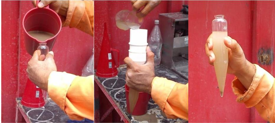
**Figura 5.1.2.5a** Prueba de contenido de arenas.
