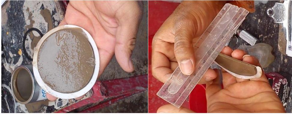
**Figura 5.1.2.3** Medición de película impermeable sobre un papel filtro (espesor).
